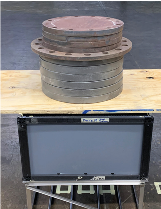
Bild 19: Eckprofil im Belastungstest (Quelle: W.L. GORE ASSOCIATES)
