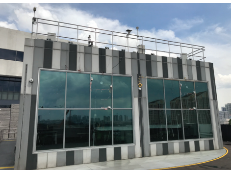
Thí nghiệm và nghiên cứu được thực hiện tại BCA Skylab: Hệ thống cửa sổ có sử dụng cầu cách nhiệt ở bên trái ảnh, và hệ thống cửa sổ thông thường ở bên phải ảnh.
